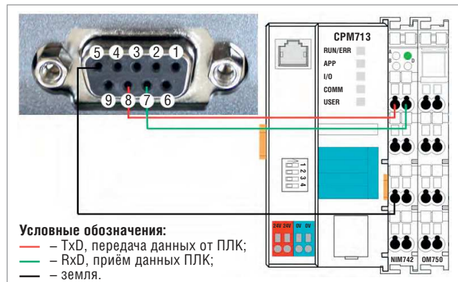
Рис. 5. Схема подключения NIM742 и панели оператора Weintek MT6100i
